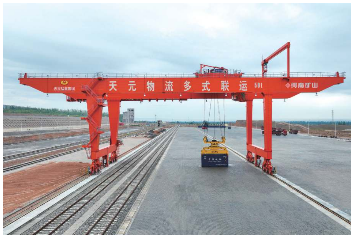
50吨集装箱门式起重机 50 t container gantry crane
